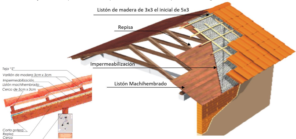
Ilustración 31 Esquema general de montaje sobre listón machihembrado.
